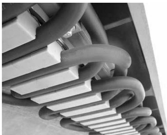
Abb. 3.9: Reale Umsetzung des Langstators
